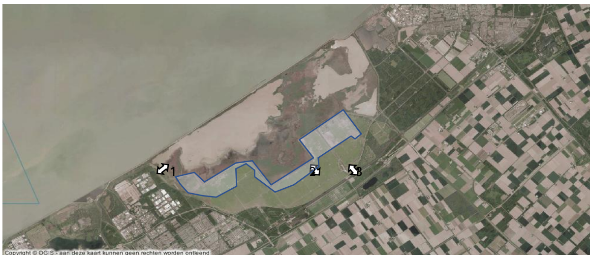
Figuur 5.1 Kaart met de locaties van de geplaatste vispassages met witte pijltjes, en blauw omljnd de zone met natte graslanden, met (1) de vispasseerbare klepstuw geplaatst in 2019, (2) DeWitt passage tussen droge graslanden en natte graslanden die in 2024 wordt afgerond en (3) de vistrap die de Lage Vaart met de Kitstocht verbindt uit 2023.
